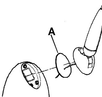
(I) Fare passare il cavo "A" e avvitare le due viti "B" di tenuta antenna.
