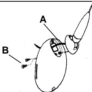
(I) Collegare l'antenna al ricevitore inserire il coperchio "A", avvitando le viti di fissaggio "B", inserire capuccio "C".
